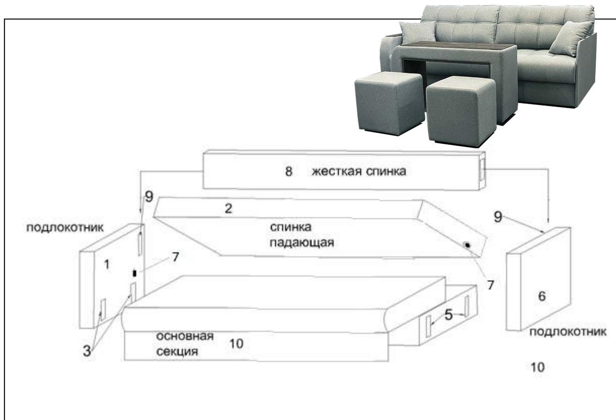
1. Соединить между собой подлокотник (1) с основной секцией (10) при помощи зацепов (3).
