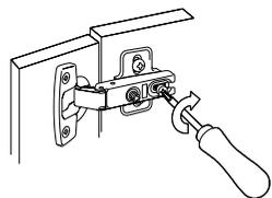
2) Затяните винт (неплотно)
