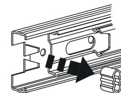
Для улучшения работы направляющей при установке системы выталкивания извлечь резиновый ограничитель хода с направляющей.
