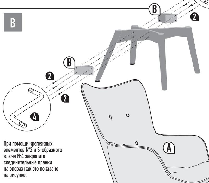
При помощи крепежных элементов №2 и S-образного ключа №4 закрепите соединительные планки на опорах как это показано на рисунке.
