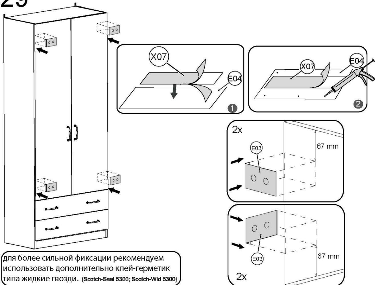
для более сильной фиксации рекомендуем использовать дополнительно клей-герметик типа жидкие гвозди. (Scotch-Seal 5300; Scotch-Wild 5300)
