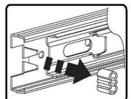
Для улучшения работы направляющей при установке доводчика извлечь резиновый ограничитель хода с направляющей.
