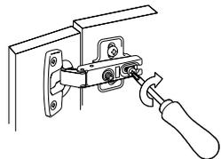
2) Затяните винт (неплотно)
