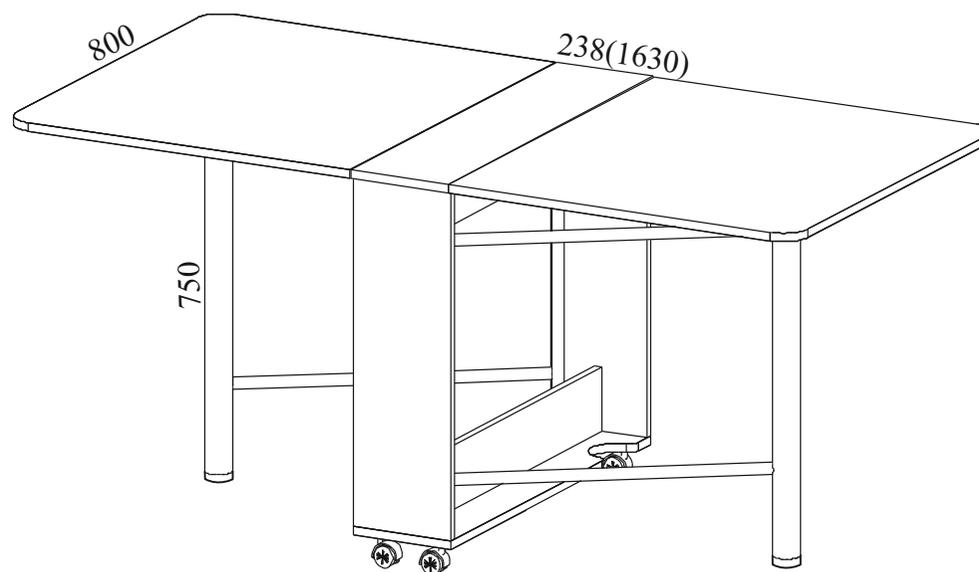
Габаритные размеры: ширина - **238(1630) мм**, высота - **750 мм**, глубина - **800 мм**.
