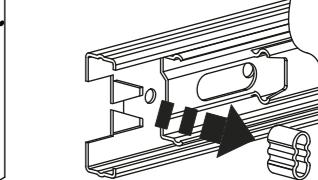
Для улучшения работы направляющей при установке доводчика извлечь резиновый ограничитель хода с направляющей.
