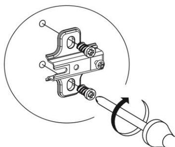
**Рис.10 - Монтаж чашки петли 36б на фасад**
