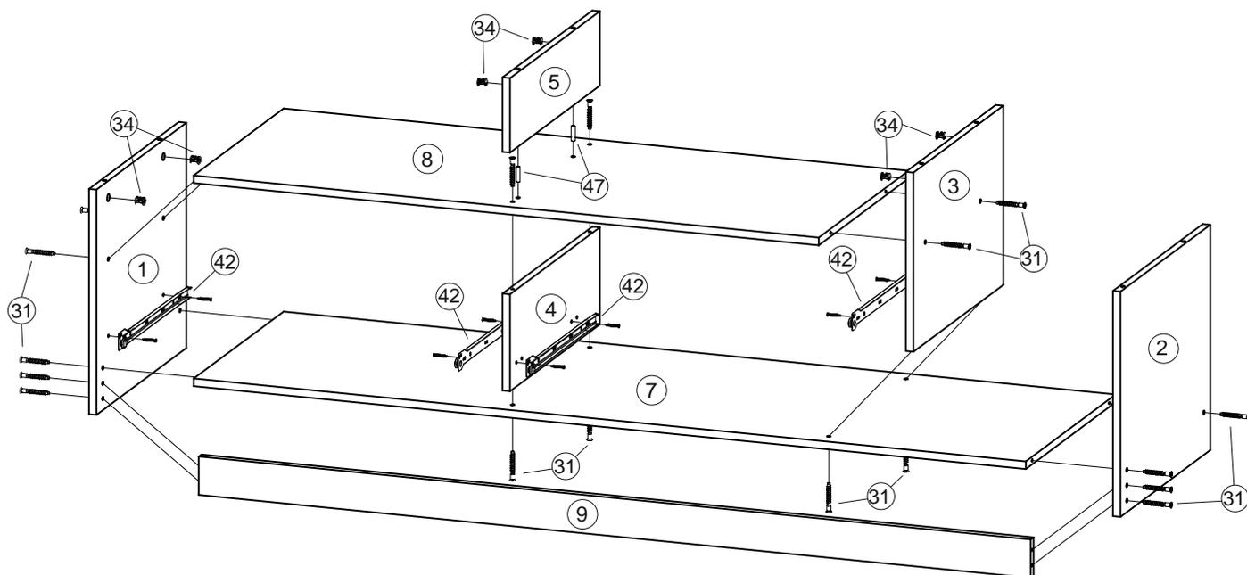
1. На Боковину(1) и Перегородки(3,4) по разметке прикрепите полозья направляющих(42) при помощи евроинтов 6,3x11,5 (31).
