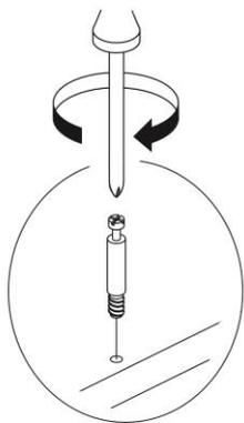
**Рис.8 - Установка и фиксация стяжки эксцентрика 34**
