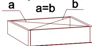
Начните сборку каркаса. Проверьте перпендикулярность и параллельность щитов и зафиксируйте с помощью задней стенки из как указано на рисунке, не нарушая диагонали. Помните, что от этого зависит правильность работы выдвигаемых ящиков и створок.
