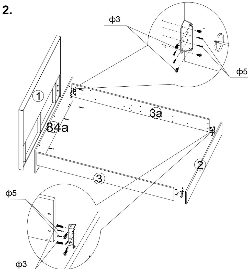
Стяните каркас с помощью уголков (ф1, ф2, ф4) как показано на схеме.
