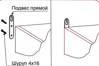
Во избежании опрокидывания шкафа, установите на задних торцевых поверхностях боковин прямой навес (см. фурнитуру) и через него притяните изделие к стене (дюбель-гвоздь в комплект не входит).
