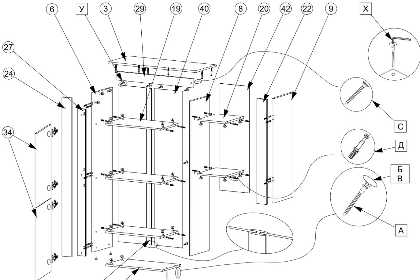
Двери (поз. 34) крепить к планке (поз. 27) при помощи петель (поз. К) Петли крепятся к планке еврошурупам (поз. Л), к двери еврошурупам (поз. Т)
