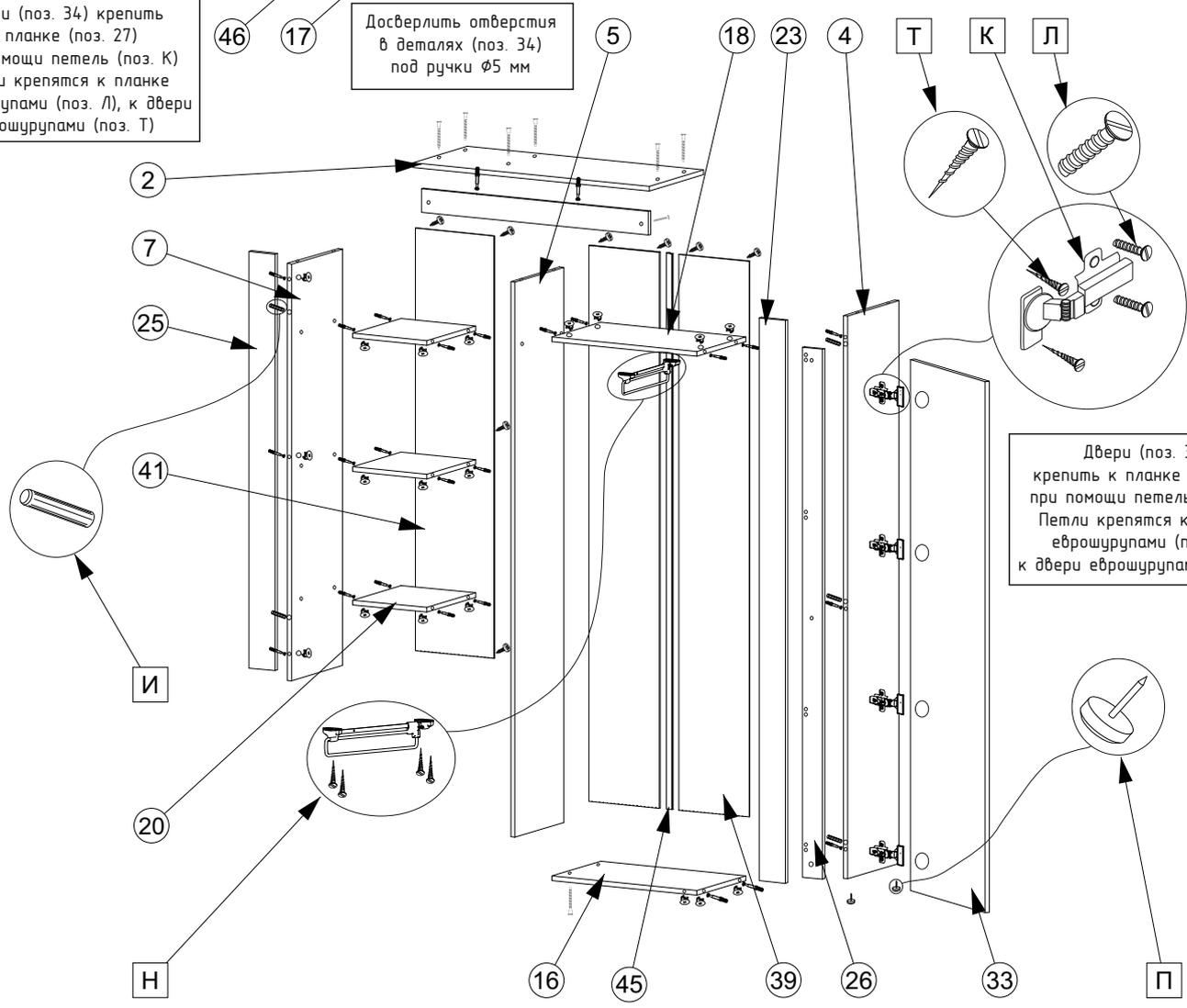
Двери (поз. 33) крепить к планке (поз. 26) при помощи петель (поз. К) Петли крепятся к планке еврошурупам (поз. Л), к двери еврошурупам (поз. Т)
