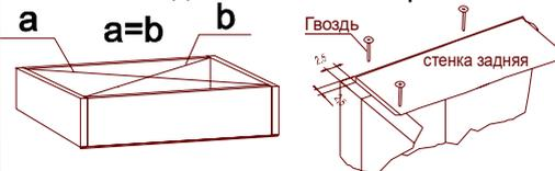
Начните сборку каркаса. Проверьте перпендикулярность и параллельность щитов и зафиксируйте с помощью задней стенки из ДВП, как указано на рисунке, не нарушая диагонали. Помните, что от этого зависит правильность работы выдвигающих ящиков и створок.
