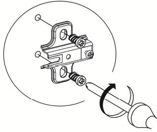
**Рис.4 Монтаж чашки петли на фасад**
