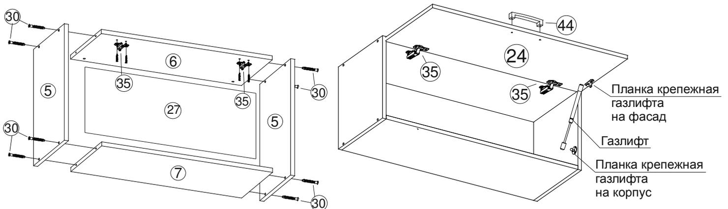
**Рис.3 Монтаж крестовины петли на боковину**
