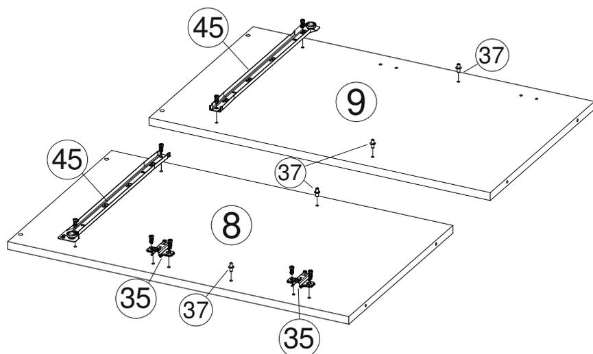
19. В соответствии со схемой на рисунке 10 в отверстия на боковинах(8,9) стола прикрутите ползья направляющих(45) при помощи евроинтов 6,3x11,5(30) и установите полкодержатели(37). На одну из Боковин(8,9) в зависимости от желаемого направления открывания дверцы прикрутите крестовины петель(35) при помощи евроинтов 6,3x11,5(30).
