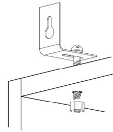
**Рис.6 Монтаж крепежных планок газлифта**
