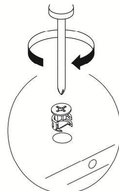
Рис.10 Установка фурнитуры на Боковины стола с ящиком
