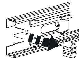
Для улучшения работы направляющей при установке системы выталкивания извлечь резиновый ограничитель хода с направляющей.
