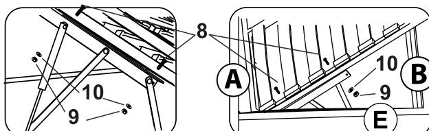
**ВНИМАНИЕ!** Газлифт крепится на подъемный механизм цилиндром вверх как на схеме.
