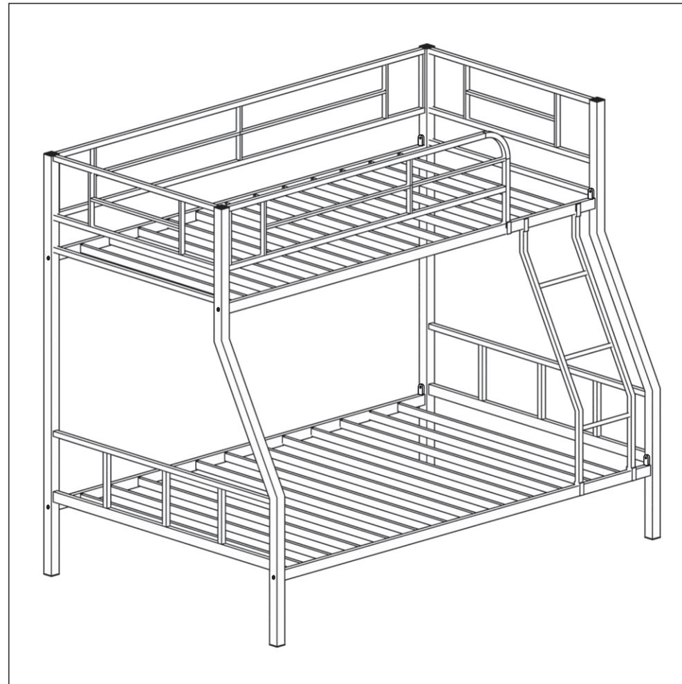
10 Установите переднее ограждение ( поз № 6 ) и закрепите винтами М8 - 20 ( поз № 9 ),
