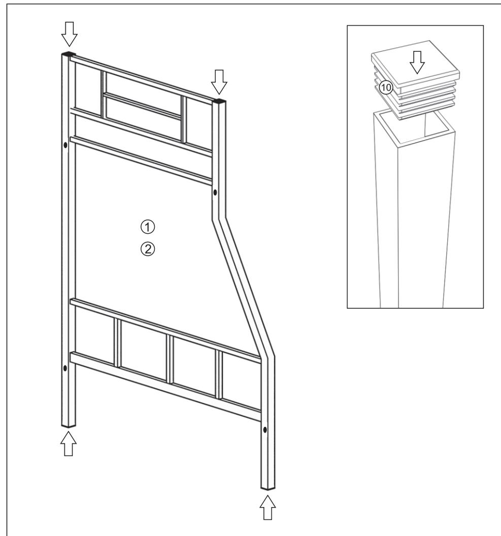
5 Удерживая боковые опоры, соедините винтами M8-55 (поз №8), винтами M8x20 (поз №9) и закрепите с нижним основанием (поз №3)
