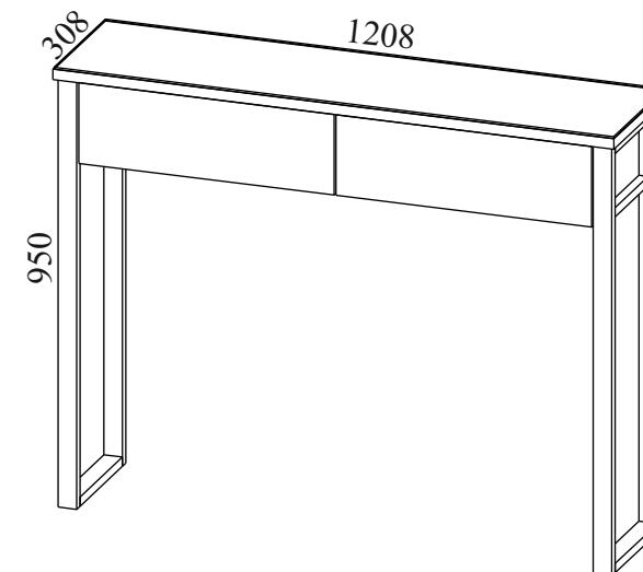
Габаритные размеры: ширина - 1208 мм, высота - 950 мм, глубина - 308 мм.
