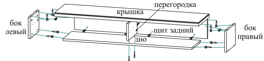
Бока крепятся к дну стяжками эксцентриковыми, перегородка - евровинтами. Щит задний крепится к перегородке, дну и бокам стяжками эксцентриковыми. Крышка крепится к бокам, перегородке и щиту заднему стяжками эксцентрика.
