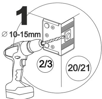
*Просверлите заднюю стенку сверлом Ø10-15 мм в центре прямоугольного отверстия на навесе.*
