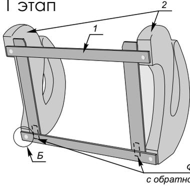
Рамку основания (1) установить фиксаторами роликов (Ф) назад и прикрепить ее к подлокотникам (2) болтами с нанизанными шайбами (Б) при помощи конфирматного ключа.
