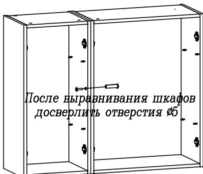
*Во избежание опрокидывания шкафа, зафиксируйте его с рядом стоящими шкафами, просверлив самостоятельно отверстия Ø8 мм в стенах вертикальных и скрепив их между собой стяжкой межсекционной.*
