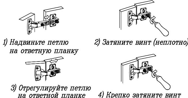
**Схема регулировки петли**
