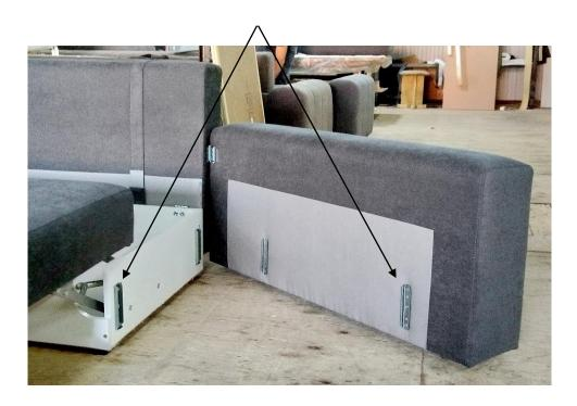
Петли опускающейся спинки вставить в карманы на коробе и закрепить винтами M6x20. Опустить спинку на короб.
