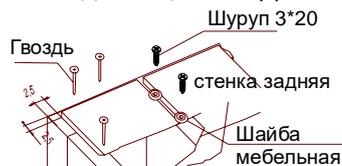
В местах стыковки задних стенок на торцах ЛДСП используйте шурупы 3\*20 и шайбы.
