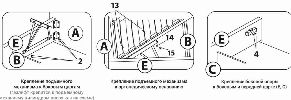
Крепление подъемного механизма к боковым царгам (газлифт крепится к подъемному механизму цилиндром вверх как на схеме)
