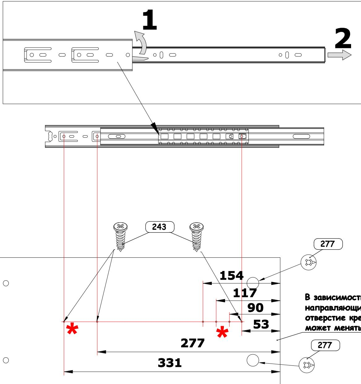
\* При желании направляющие можно крепить дополнительными шурупами 4x13.
