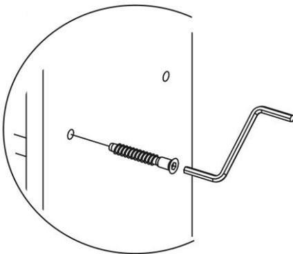
Рис.8 - Монтаж задних стенок на стыке
