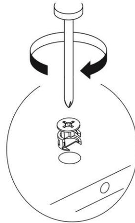
Рис.7 - Установка евровинта 25
