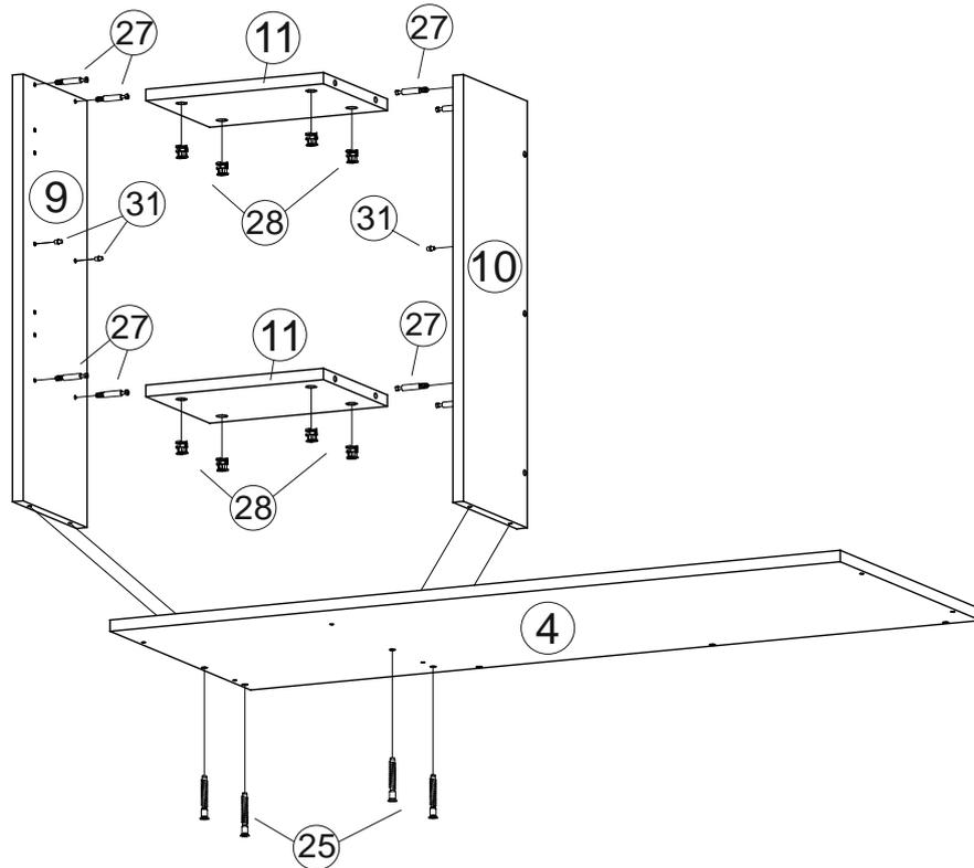
**Рис.2 Сборка нижней части каркаса**
