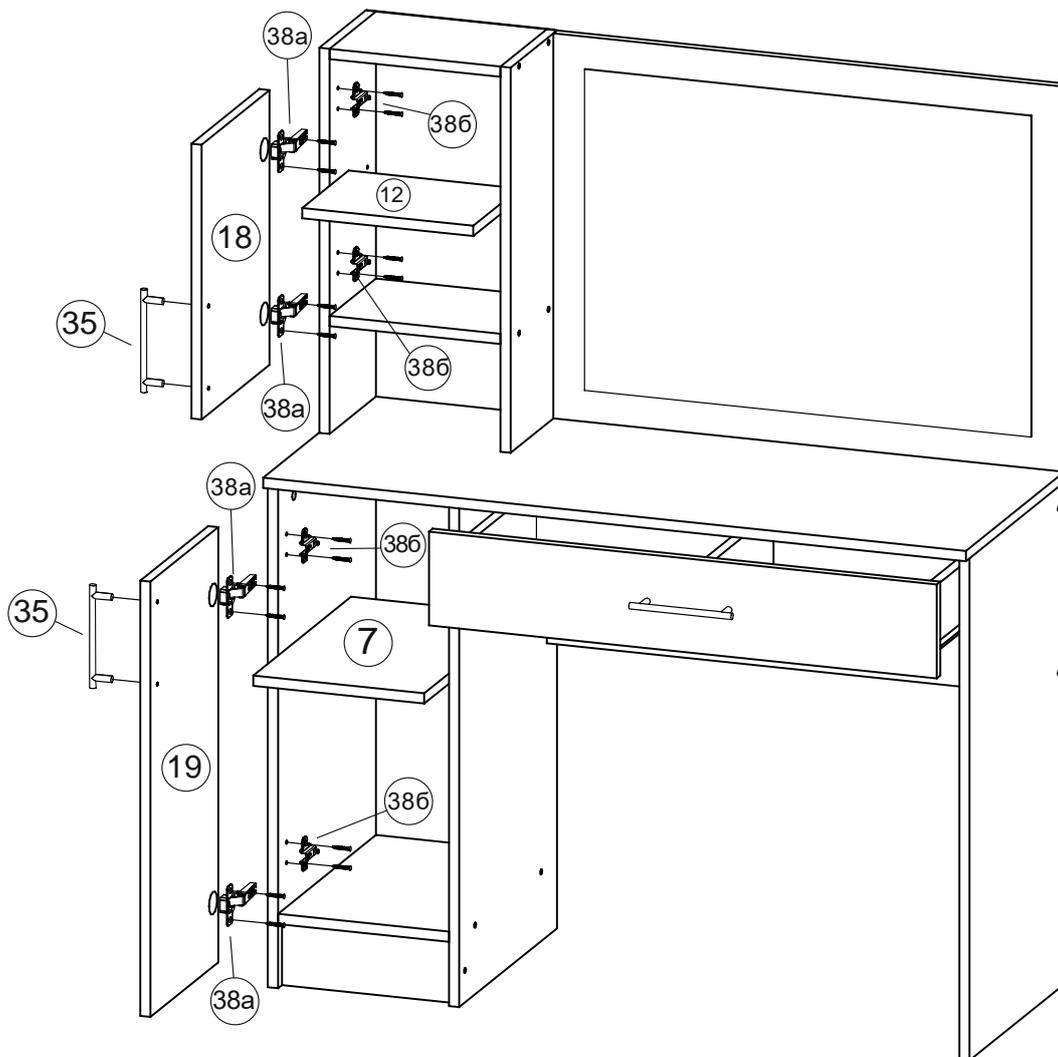
Рис.10 - Монтаж крестовины петли на боковину 38б
